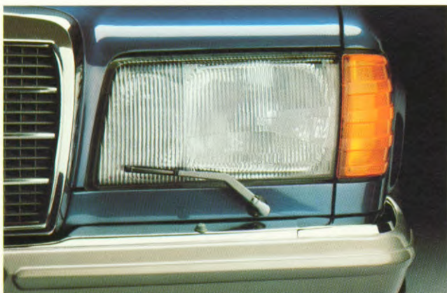
Geïntegreerde halogeen koplampen met om de hoek doorgetrokken knipperlicht.
