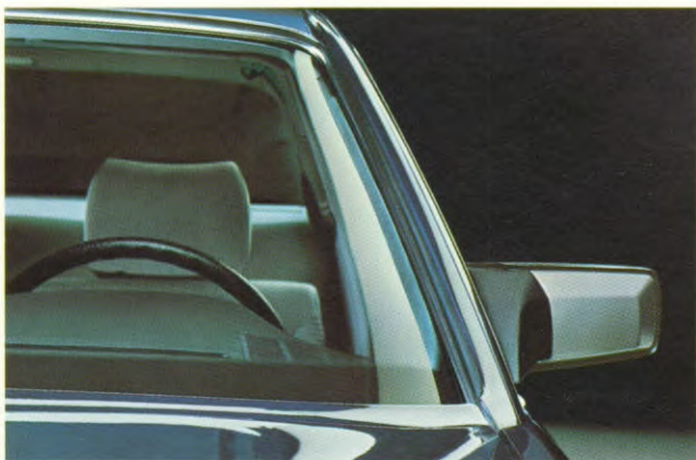
Voorruitstijl met verzonken regengoot en aerodynamisch gevormde zijspiegel, van binnenuit verstelbaar.
