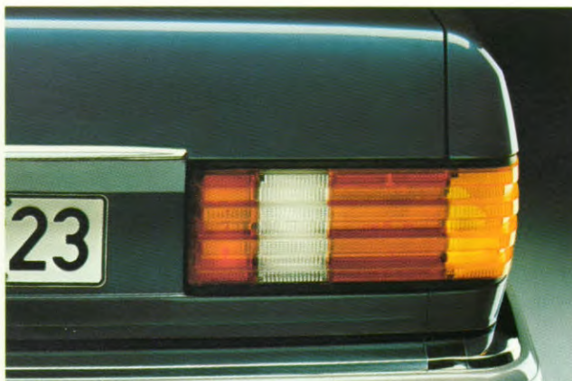
Achterlichten met karakteristieke vuilwerende dwarsribbels.
