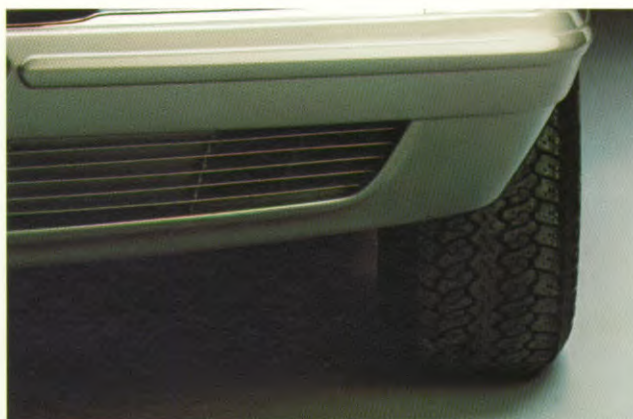
De bumpers vangen lichte stoten op zonder karrosserieschade.
